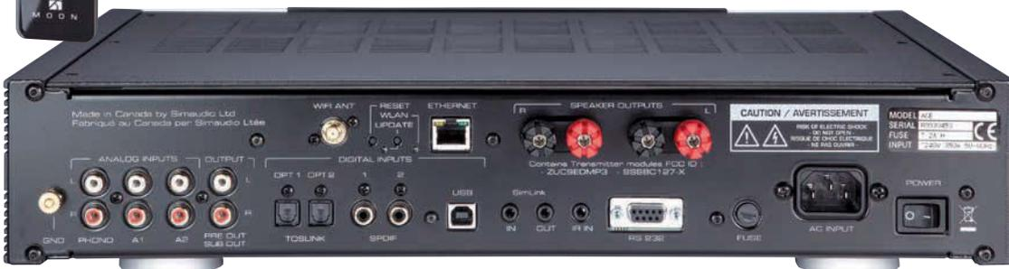
◀ Der Moon weist Anschlüsse für bis zu vier analoge und fünf digitale Geräte, Vorstufen- und Lautsprecheranschlüsse plus WiFi, LAN und Bluetooth auf.
